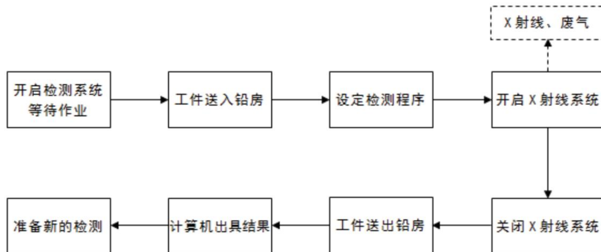
图 5.6 X 射线检测系统的生产工艺流程示意图
